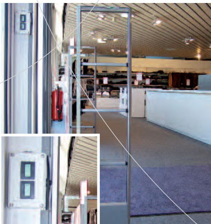
In der simpelsten Konfiguration liefern wir den Messwert auf ein Display, das mittels Schlüssel nach dem Ablesen wieder auf Null gesetzt wird
